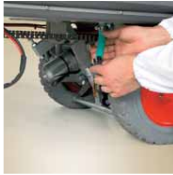
Descarga del líquido residual que se haya quedado eventualmente en el hueco de las baterías
